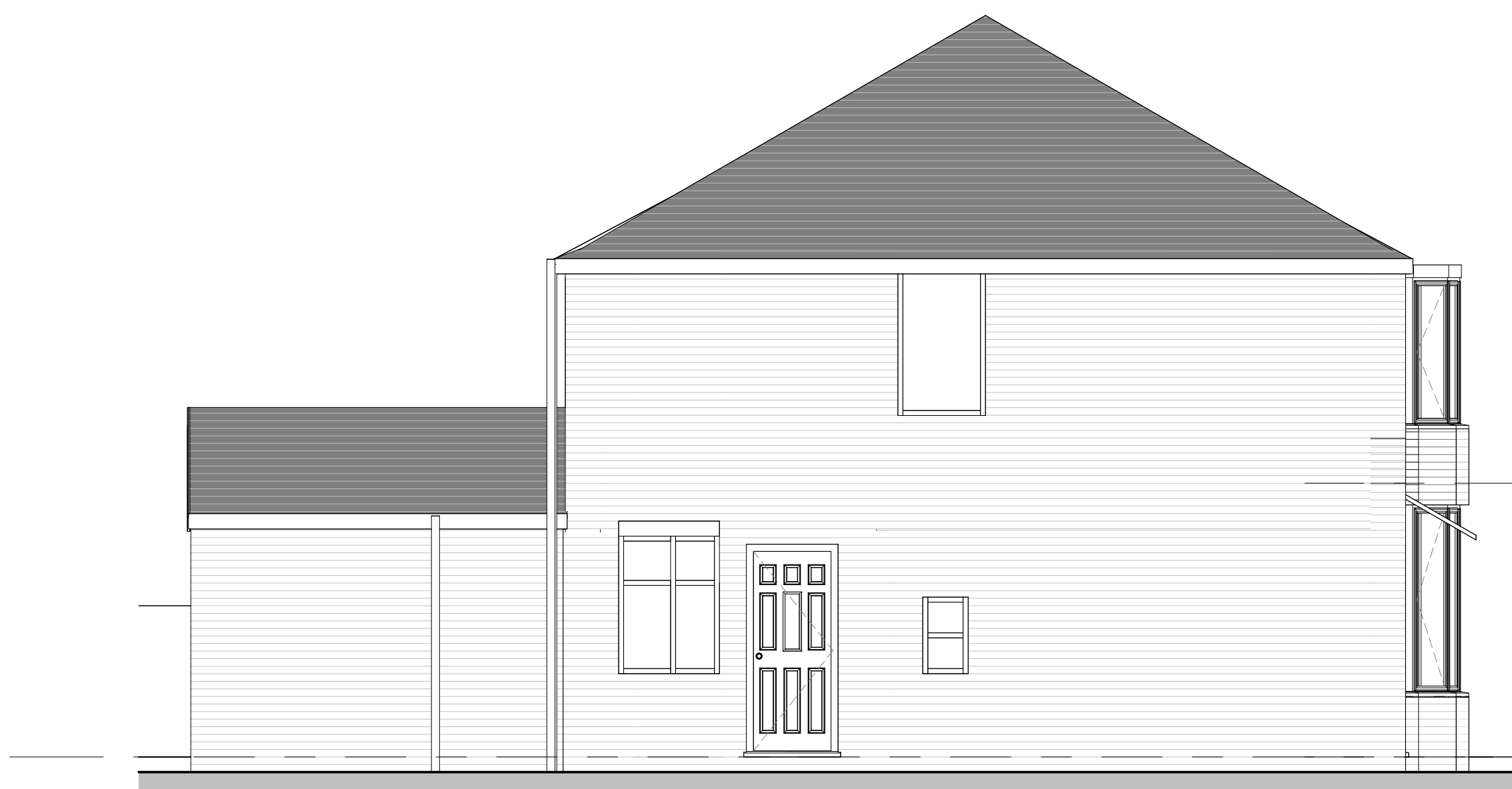
E3 EXISTING SIDE ELEVATION 1: 50
