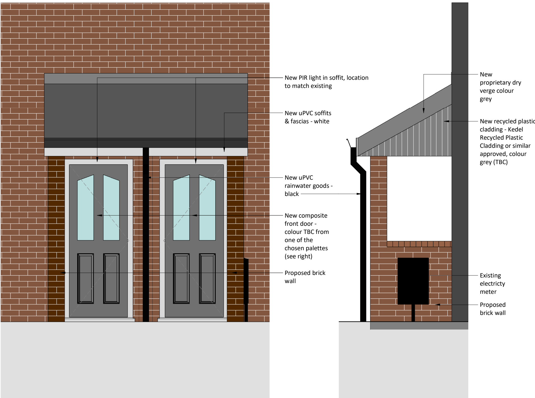
Front Elevation 1:25 TYPE 2 Flats 4 & 5, 12 & 13
