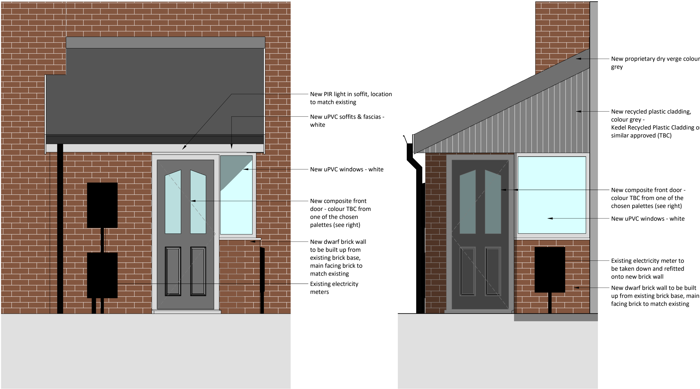
Front Elevation 1:25 TYPE 3 Flats 1 & 2
