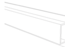
8 Perfil Omega (Aluminio) Omega Profile (Aluminum)
