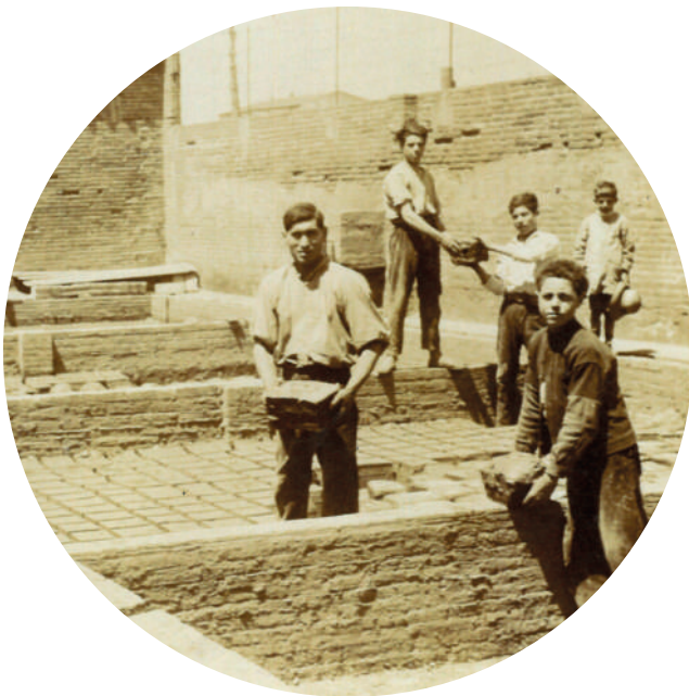
Preparation of clay in settling ponds in L'Hospitalet factory, early 20th century Aufbereitung der Tonerde im Absetzbecken der früheren Fabrik in L'Hospitalet (Anfang des 20. Jahrhunderts)
