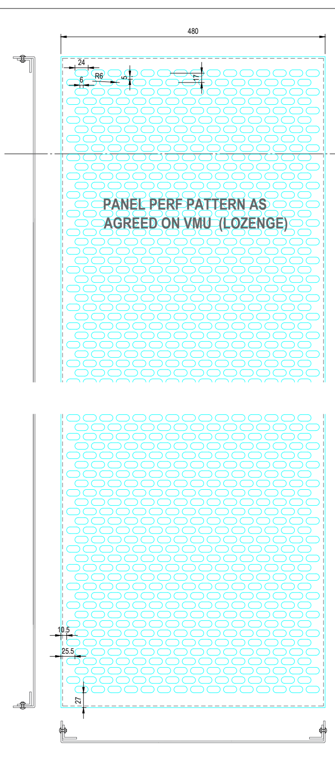
PANEL EDGE DETAIL (Scale 1:1)
