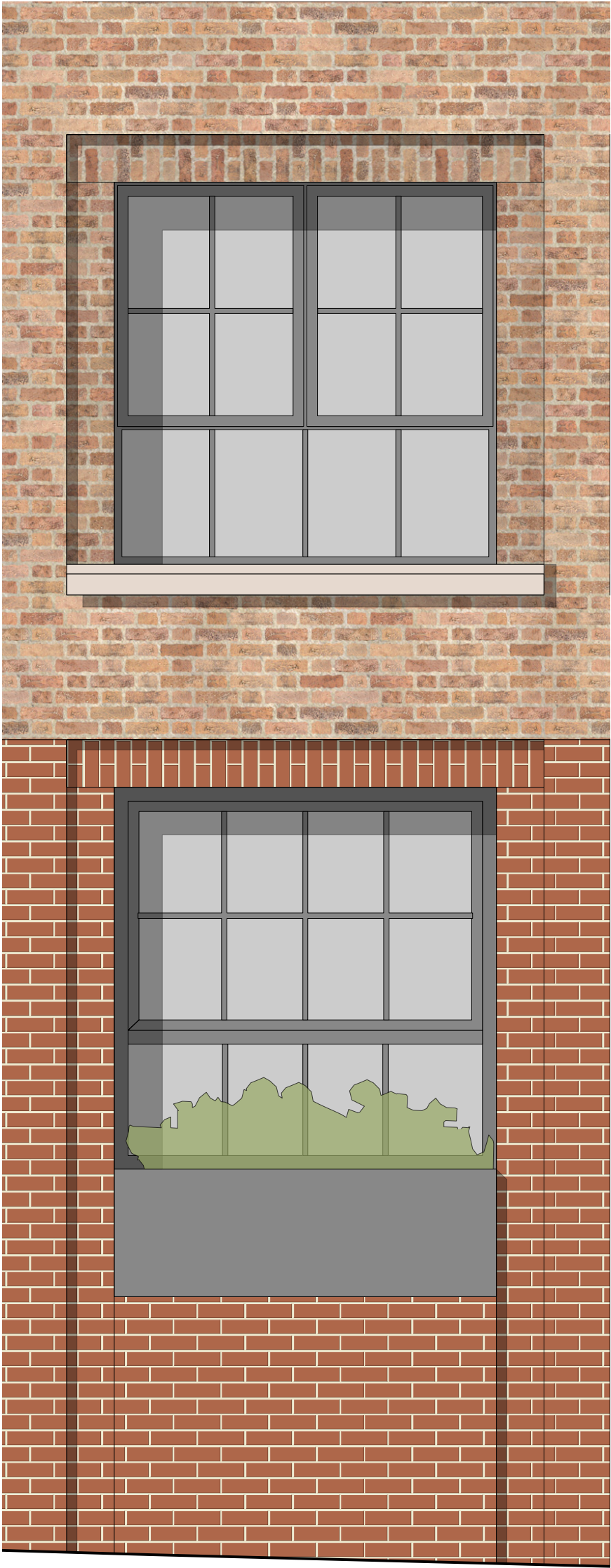
DETAIL ELEVATON BB 1:25@ A3
