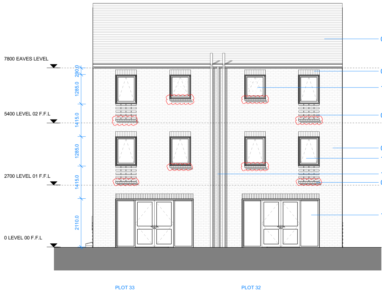
7 | HT D1 - 4B5P M4(1) - REAR ELEVATION 1:100
