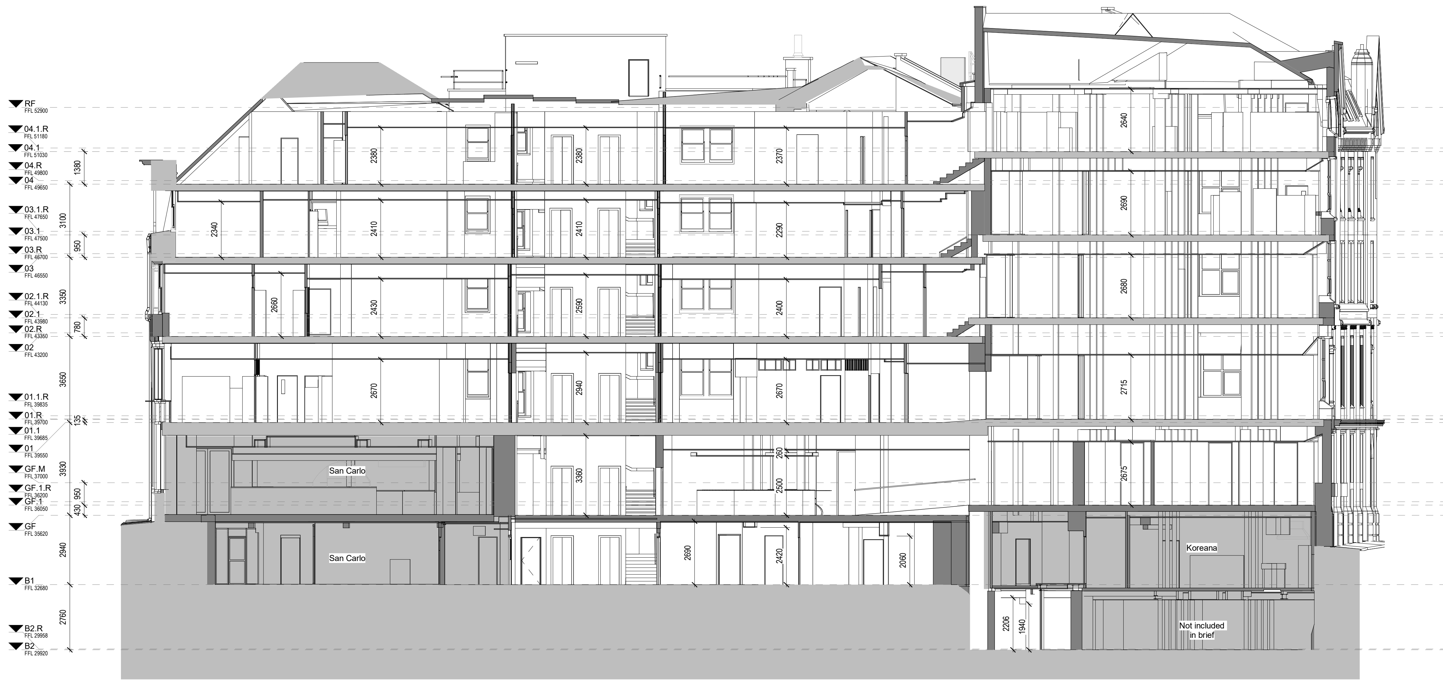
Existing Longitudinal Section AA 1:100
